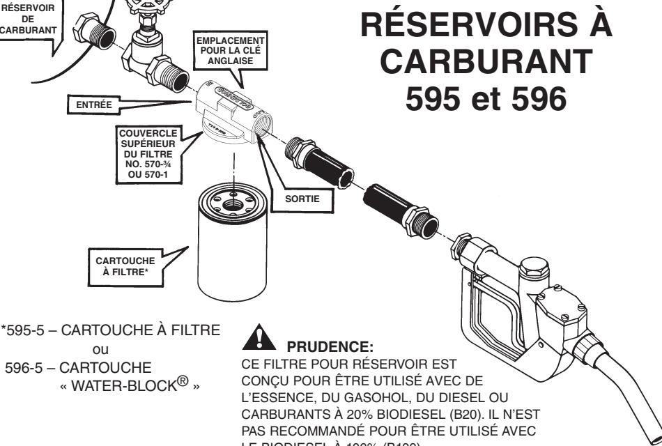
**IMPORTANT:** Toujours situer la valve d'arrêt entre le filtre et le réservoir.
